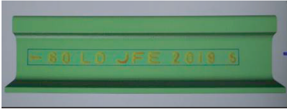
図5 欠陥のラーニング例（レール浮出文字）
